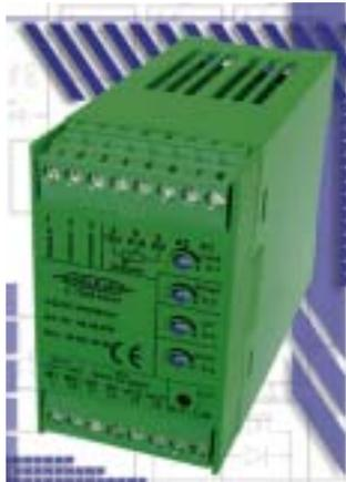
zugleich, damit ein konstanter Gleichlauf erreicht wird. Der Trimmer Tr.4 bestimmt den maximal zulässigen Motorstrom. Beim Erreichen des eingestellten Überstroms leuchtet eine LED auf der Frontseite der Steuerung und der Ausgang an der Klemme 16 wird von 0V auf VCC geschaltet. An dem digitalen Eingang „I-Umsch.“ kann zwischen Stromabschaltung oder Strombegrenzung gewählt werden. Bei Stromabschaltung wird
