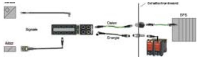
Die neuen Module von Weidmüller sind in RT-Netzwerken als Slave, kompatibel zu IRT-Netzwerken in Linien-, Stern- oder Baum- Netzwerkstrukturen einsetzbar.
