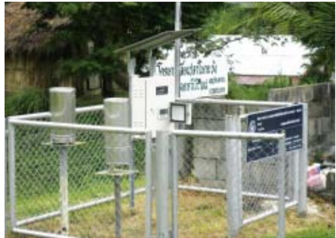
Eine Messstation des Frühwarnsystems.
