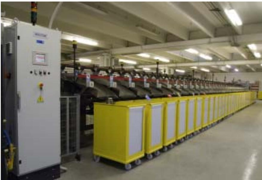
Bücherkommissionierungslinie mit Barcode-Erfassung in Echtzeit und PC Simatic Microbox 427B-HMI/RTX
