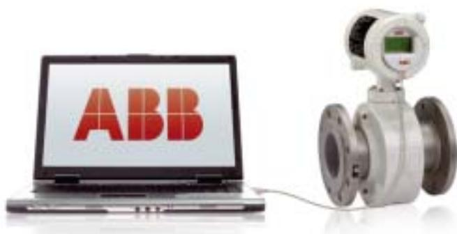
**Über die moderne Infrarotschnittstelle können Gerätedaten für Servicezwecke ausgelesen werden, ohne dass der Messumformer demontiert werden muss. Die Schnittstelle kann ebenfalls verwendet werden, um Firmware zu aktualisieren, zukünftig Diagnosefunktionen zu ergänzen, Sprachpakete zu laden oder um eine Dokumentation der Messstelle zu erzeugen.**
