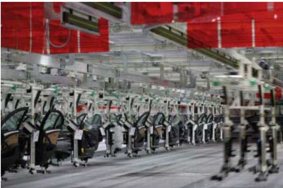
Das neue Speicher- und Transportsystem für Türen im BMW Werk Dingolfing gewährleistet flexible und sichere Abläufe. Hier kommt zenon zum Einsatz.
