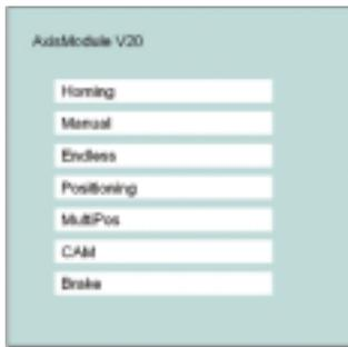
**Bild 3: Struktur und Funktionalitäten des Software-Bausteins AxisModule.**
