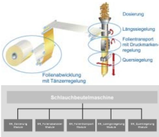
**Bild 1: Abbildung der Funktionen einer Schlauchbeutelmaschine auf eine modulare Softwarestruktur in einer Ebene mit Hilfe des Templates und so genannten Equipment-Modulen („SR\_... Module“).**
