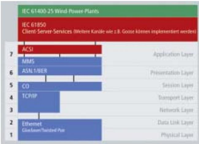
Bild 1: Kommunikationsstack nach IEC 61850/IEC 61400-25.
