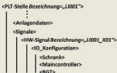
BILD 3: Die beispielhafte Zuordnung von Attributen der I/O-Konfiguration eines geplanten Signals zur ihm übergeordneten PLT-Stelle; das Signal „LI001_X01“ kann eindeutig zugeordnet werden.
