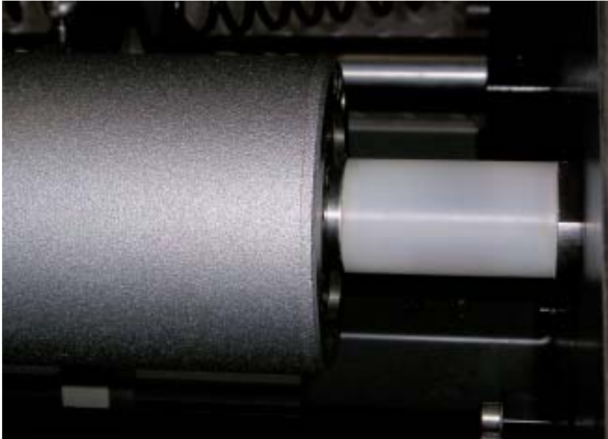
Bild 3: Um die Kraft, die auf die Umlenkrolle wirkt, zu messen, sind in den Wellenzapfen Dehnungsmessstreifen von HBM eingebaut (Abbildung: Koenig & Bauer AG).
