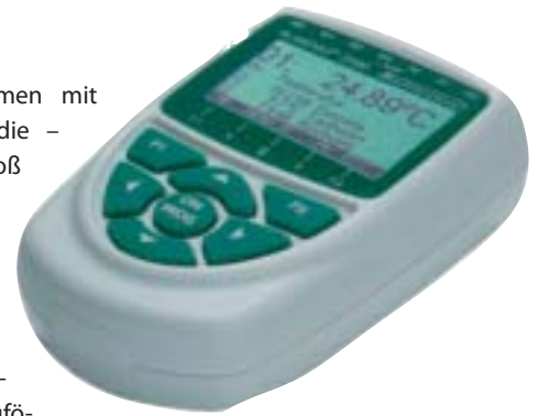
Bild 5: Datenlogger für Globe-Temperatur berechnet den PPD-Wert.
