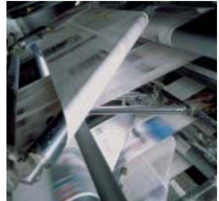
Bild 2: An einer Umlenkrolle, über die die Papierbahn läuft, kann die Bahnspannung gemessen werden (Abbildung: Koenig & Bauer AG).
