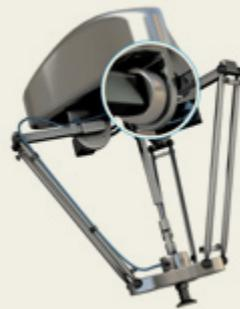
**DELTA-ROBOTERN VERLEIHEN** die Zykloidgetriebe von Nabtesco ein hohes Maß an Präzision und Dynamik.
