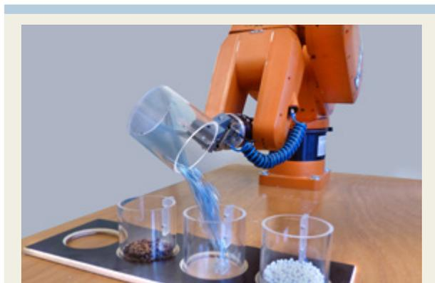
**DER ROBOTER** kann am Schüttgeräusch erkennen, um welches Material es sich handelt. Bild: Fraunhofer IDMT
