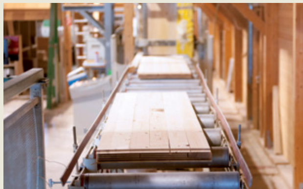
MIT EINEM AUFWENDIGEN GENERAL-KEILZINKENSTOSS werden die Lignotrend-Rohlinge stirnseitig zu langen geradlinigen Endlos-Elementen verklebt. Bilder: Leuze Electronic
