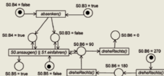
BILD 7: Ausschnitt aus dem Petrinetz der Stempelanlage
