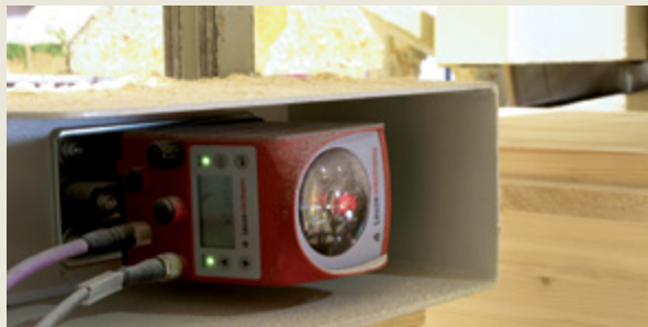
DAS LASER-DISTANZMESSGERÄT AMS 304i lässt sich vom Staub nicht stören.
