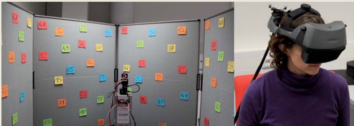
BILD 10: Evaluation des kopfbewegungsgesteuerten Stereokamerasystems anhand einer Suchaufgabe im Labor
