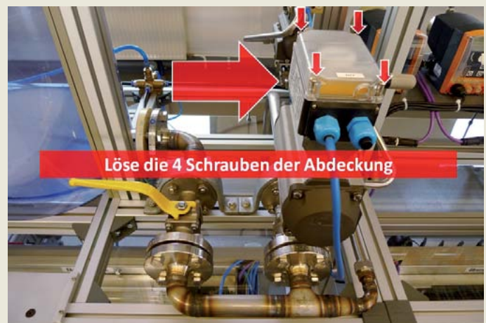
BILD 8: Beispielhafte AR-Einblendung zur Nutzerunterstützung
