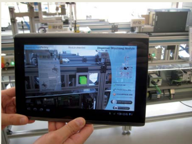
BILD 7: Screenshot der am Tablet-PC augmentierten Anlage
