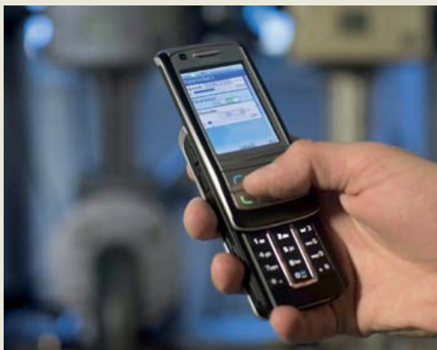
BILD3: Steuerung der FlowUnit über ein Nokia 6280
