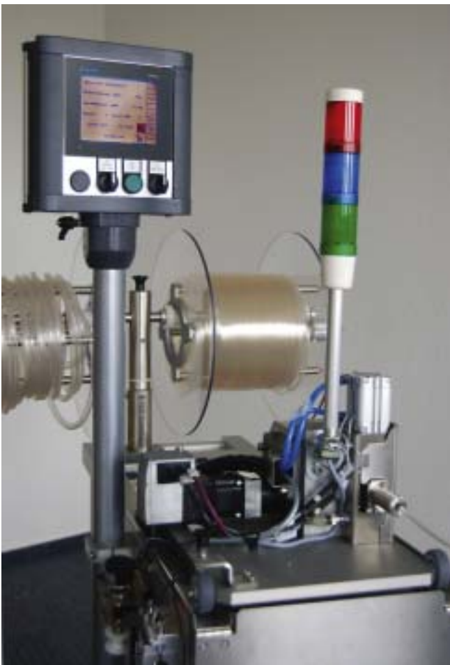
Bild 1: Schlauchschneidemaschine, mit der sich einzelne Schläuche für Dialysegeräte oder komplette Schlauchsets automatisch mit den jeweils benötigten Abmessungen ablängen lassen (Foto: Woll/Schneider Electric).
