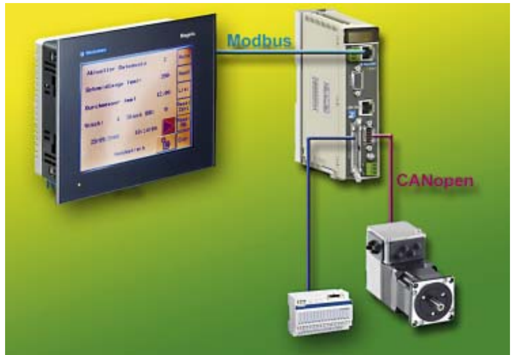
Bild 2: Die für die Schlauchschneidemaschine maßgeschneiderte Automatisierungslösung besteht im Wesentlichen aus Bedienterminal, einem kompakten Servoantrieb und einem Motion-Controller (Foto: Schneider Electric).
