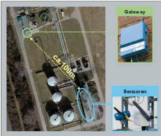
**BILD 5:** Pilotinstallation Rückkühlwerk für Temperatur und Füllstandsüberwachung
