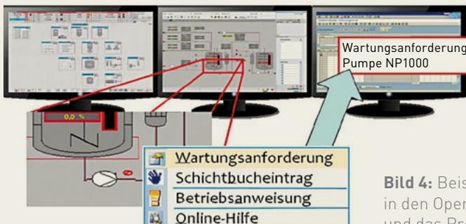
**Bild 4:** Beispiel der ERP Integration in den Operatorarbeitsplatz und das Prozessleitsystem.
